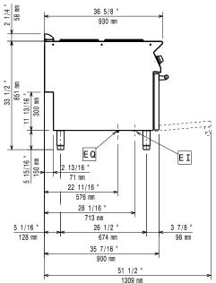
Electrical inlet (power) ΕI EQ Equipotential screw
